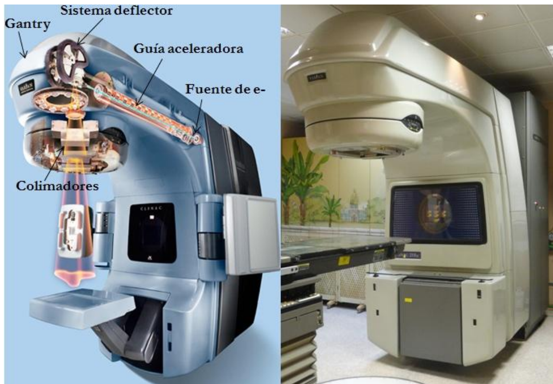
Figura 5. Esquema general de un acelerador lineal de uso clínico de última generación (Izquierda) ( www.varian.com ). Se ilustra la fuente de electrones, la guía aceleradora, el sistema deflector magnético y las mordazas de colimación. La imagen de la derecha muestra el acelerador lineal Varian Clinac 21 EX, instalado en la Clínica La Luz de Madrid, con el cual se han realizado las medidas presentadas en el capítulo 4 de este trabajo .
